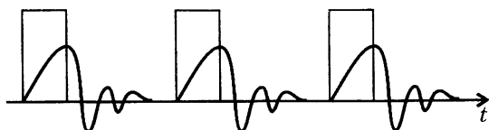
Рис.44. Прямоугольные импульсы имитируют периодические возмущения крыла; «отклик» на эти возмущения успевает затухнуть между двумя последовательными импульсами
